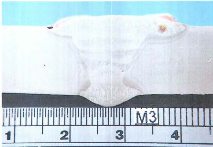
Gambar 4.8. Foto Struktur Makro Hasil Las di Lingkungan Laut
