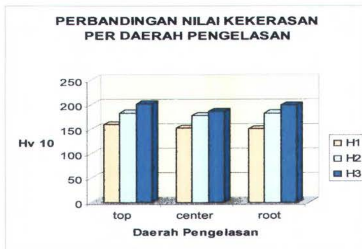
Gambar 4.17. Perbandingan Nilai Kekerasan Per Daerah Pengelasan
