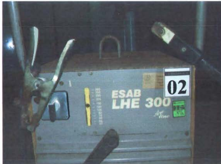
Gambar D-1. Mesin Las SMAW Merek ESAB LHE 300 dengan Tang Massa ( Work Lead ) dan Electrode Holder
