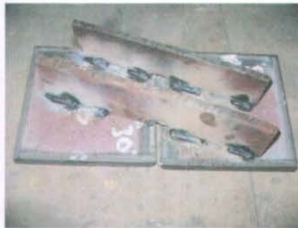
Gambar 3.3. Pemasangan Tanggem Las
