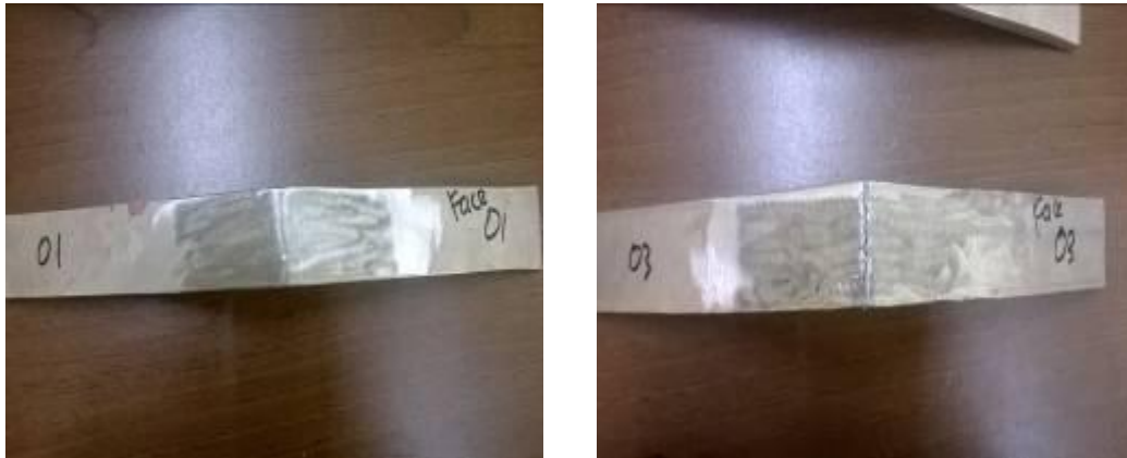
Gambar 4-29 Hasil Face bend pengelasan dengan landasan marmer
