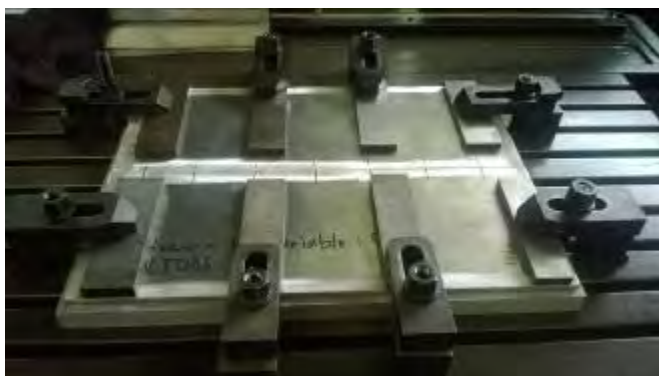
Gambar 3-6 Pemasangan rigid clamp
