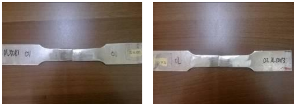
Gambar 4-25 Pengujian tarik hasil pengelasan dengan landasan Al 5083
