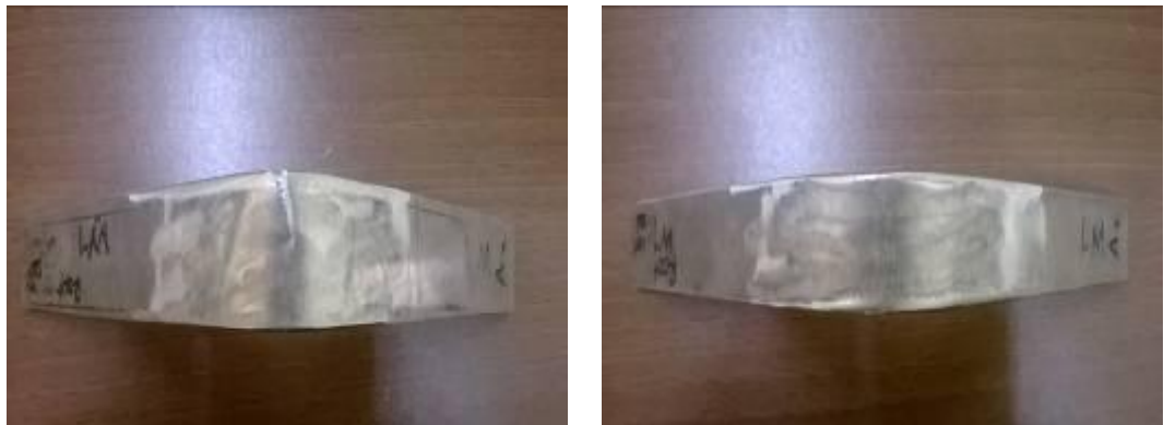
Gambar 4-32 Hasil uji root bending pengelasan dengan landasan Marmer
