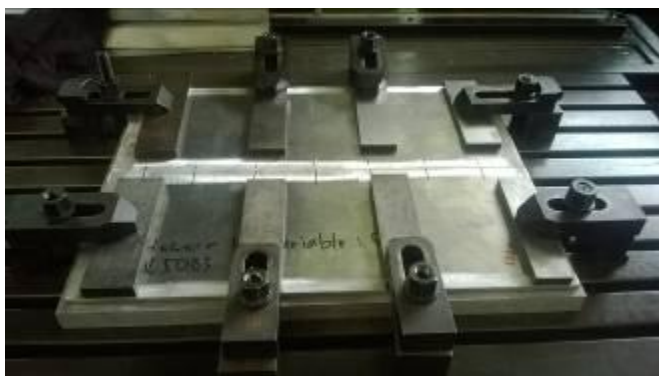
Gambar 3-6 Pemasangan rigid clamp
