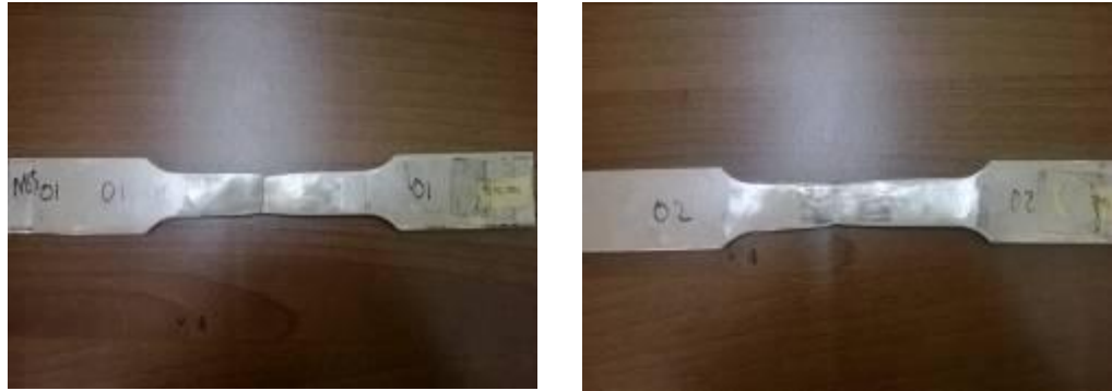
Gambar 4-24 Pengujian tarik hasil pengelasan dengan landasan mild steel
