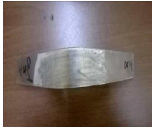
Gambar 4-27 Hasil face bend pengelasan dengan landasan mild steel
