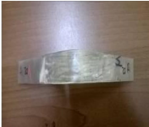
Gambar 4-27 Hasil face bend pengelasan dengan landasan mild steel
