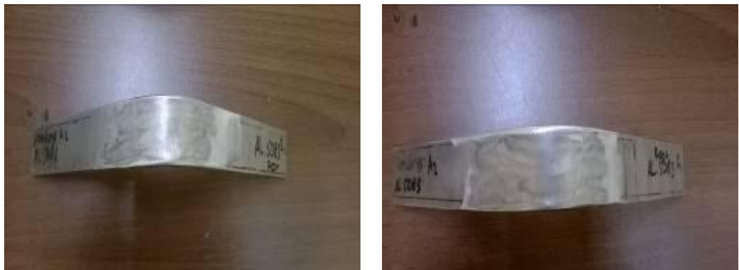
Gambar 4-31 Hasil uji root bending pengelasan dengan landasan Al5083
