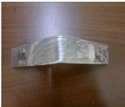
Gambar 4-28 Hasil Face bend pengelasan dengan landasan Al 5083
