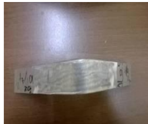
Gambar 4-28 Hasil Face bend pengelasan dengan landasan Al 5083
