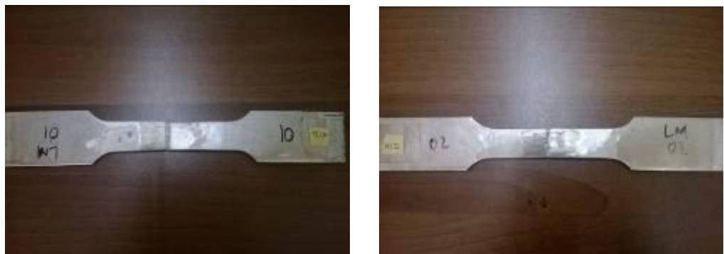
Gambar 4.26 Pengujian tarik hasil pengelasan dengan lanasan marmer
