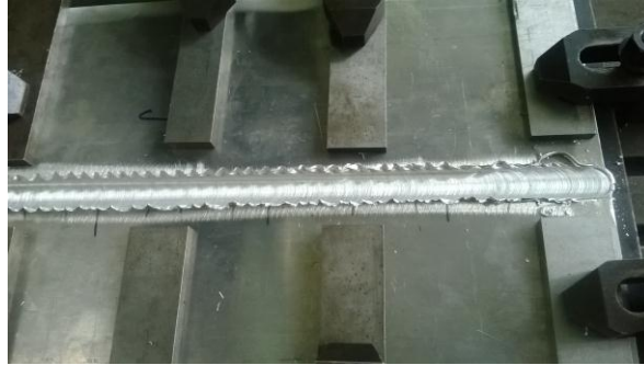
Gambar 4-4 Hasil pengelasan perlakuan variasi landasan mild steel
