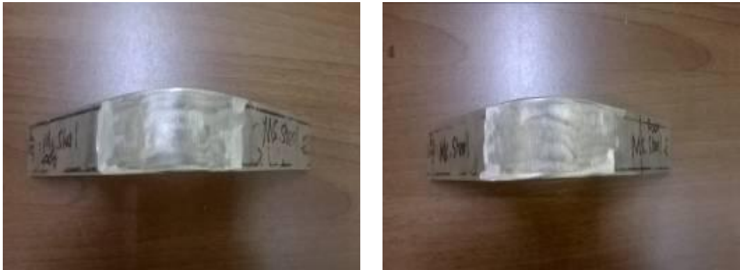
Gambar 4-30 Hasil uji root bending pengelasan dengan landasan Mild Steel
