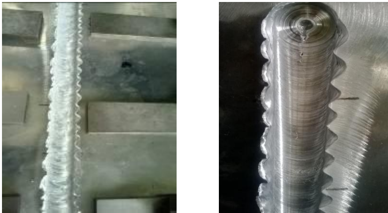
Gambar 4-5 Hasil pengelasan perlakuan variasi landasan marmer
