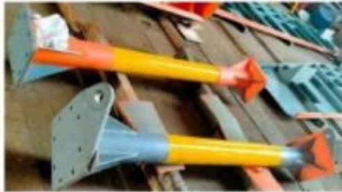
Gambar 4. 31 Hasil pemasangan Rubber Lining pada Cross Tie Sumber : dokumen pribadi
