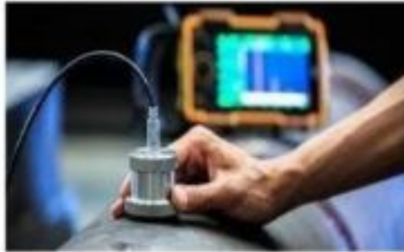
Gambar 4. 17 Proses UT & MT Test Sumber : dokumen pribadi
