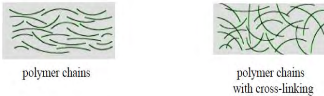
Gambar 15 Rantai Polymer, Rantai Polymer dengan cross linking
