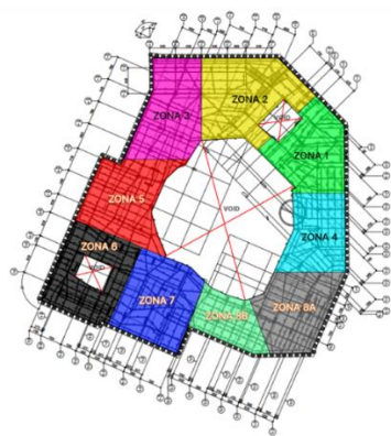
Gambar 3.63 Pembagian Zoning Pekerjaan
