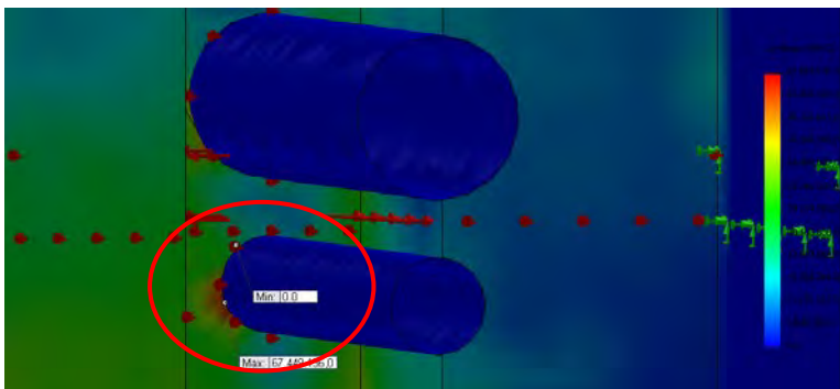
Gambar 4.24 Detail daerah dengan tegangan maksimum corrugated watertight bulkhead
