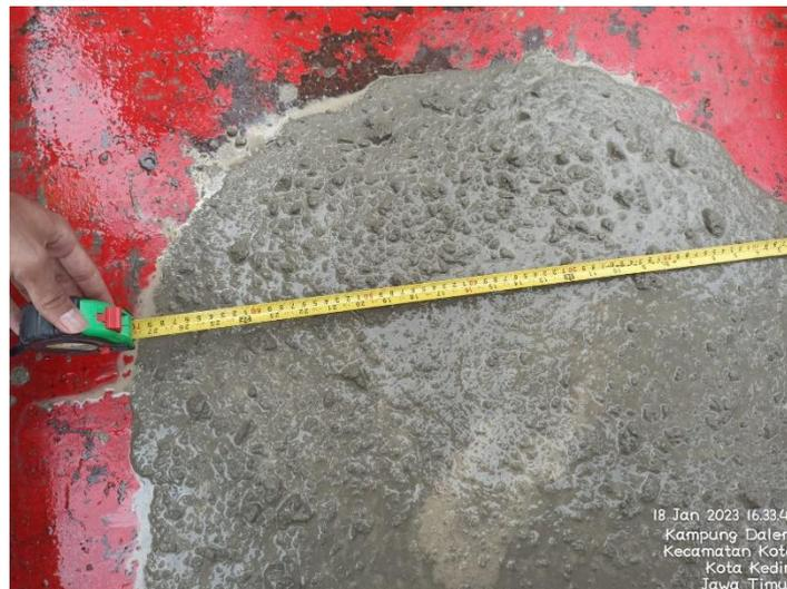
Gambar 5.4 Hasil *Slump Flow Test* Setelah Penambahan Zat Adiktif
