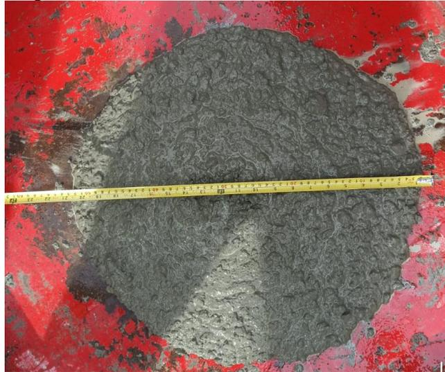
Gambar 5.3 Hasil *Slump Flow Test* Sebelum Penambahan Zat Adiktif
