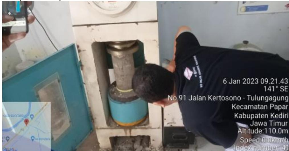
Gambar 4.8 Kuat uji tekan beton
