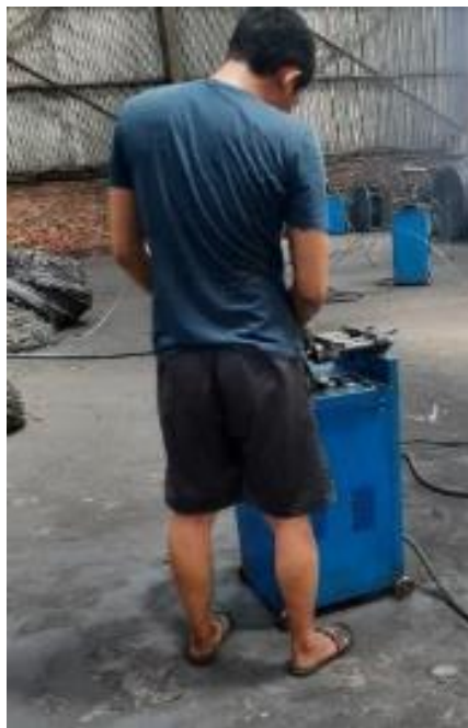
Gambar 4.57 Operator yang tidak memakai APD ketika bekerja
