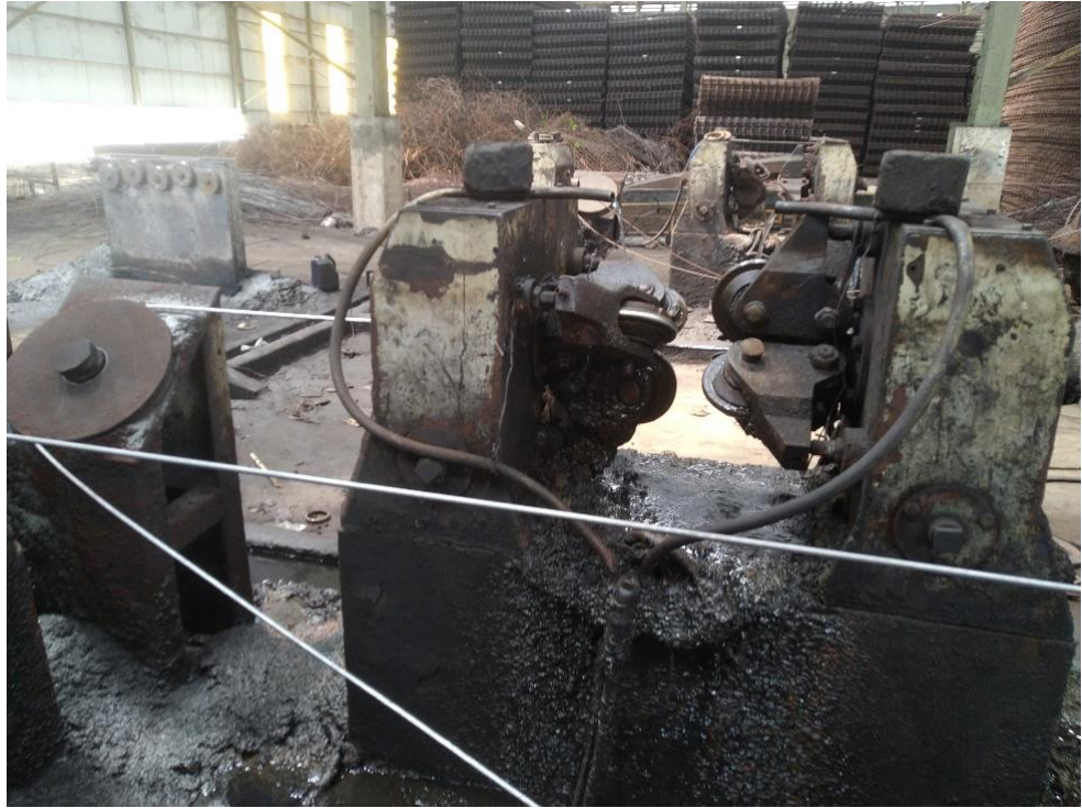
Gambar 4.22 Wire Rolling Mills Bagian 2 untuk membuat ulir pada wire rod
