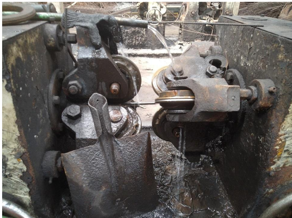
Gambar 4.21 Wire Rolling Mills Bagian 1 untuk mengurangi diameter pada wire rod
