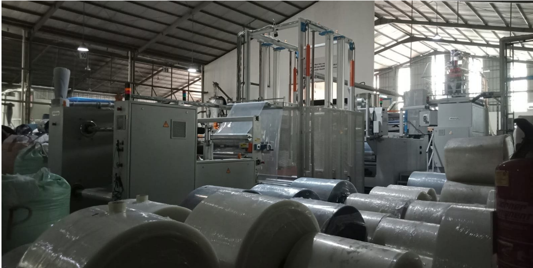
Gambar 4.18 Ruang Produksi Roll Plastik (extruder) [Sumber: Dokumentasi pribadi]
