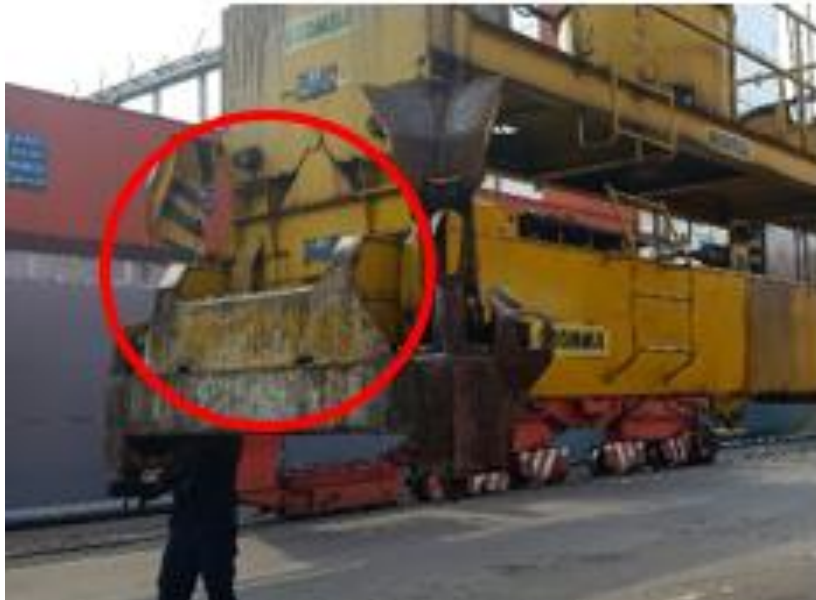
Gambar 4. 71 End Beam Spreader SSX40 Bromma pada Container Crane 05
