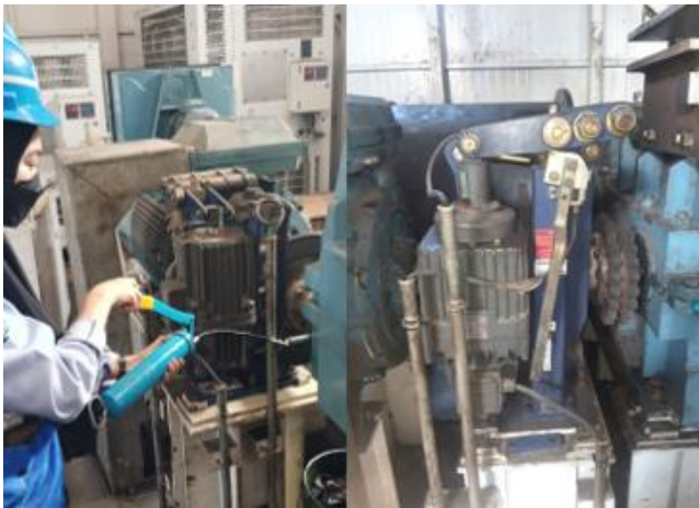
Greasing pada titik neaple greas menggunakan grease gun pada thruster brake container crane
