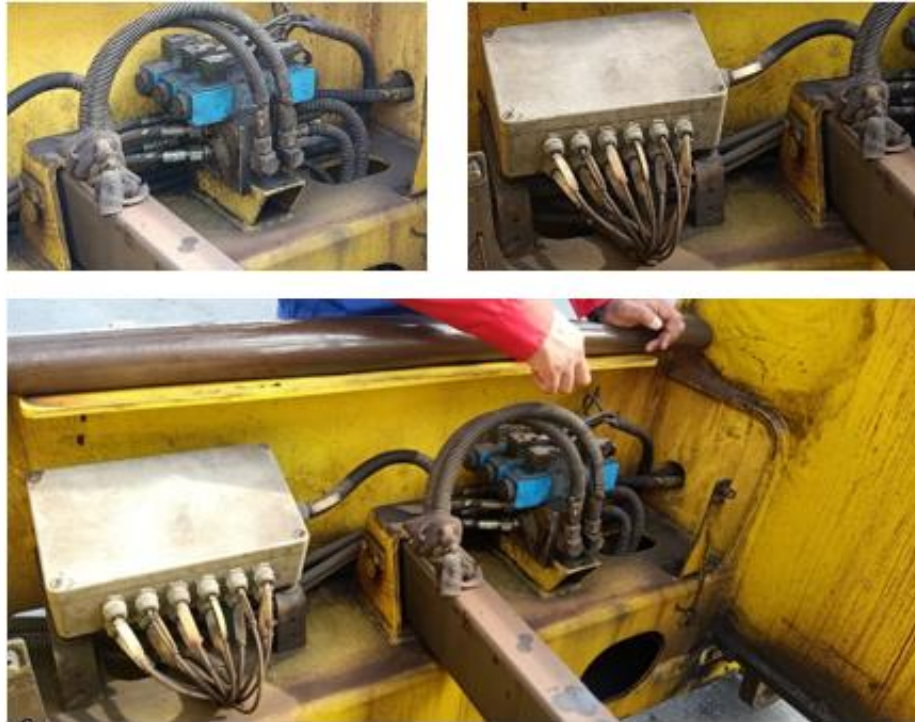
Gambar 4. 79 System Control dan Solenoid Valve Twistlock dan Flipper (Sumber : Dokumen Pribadi)
