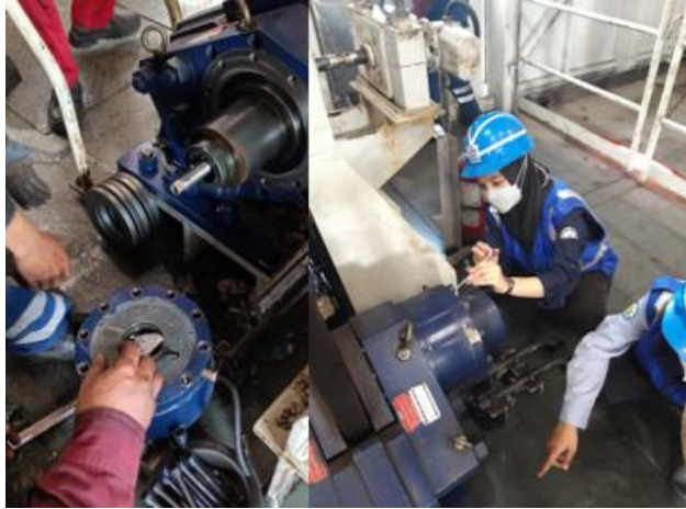
Pergantian dan pemasangan Seal pada emergency brake hoist pada Container Crane 05
