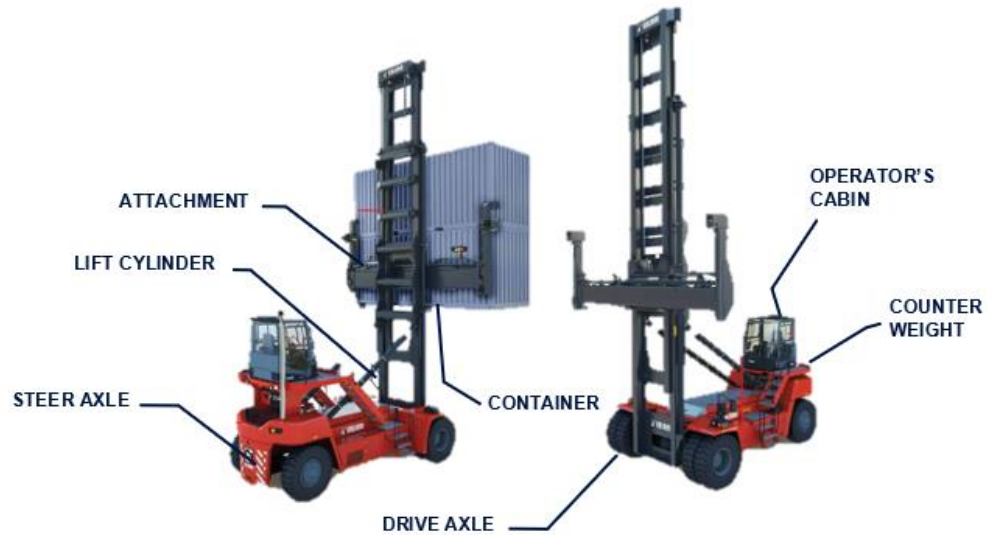
Gambar 4. 9 komponen – komponen Side Loader (SL) Kalmar (Sumber : PPT Penugasan Magang Industri Alat Bongkar Muat Pelabuhan)
