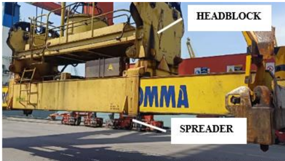
Gambar 4. 41 Spreader Bromma SSX40 pada Container Crane 05
