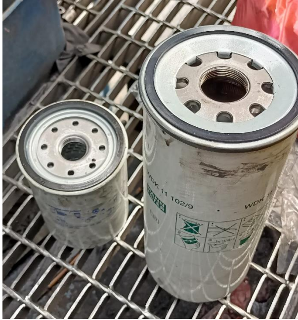
Pergantian dan Pemasangan Filter Oli pada alat RTG
