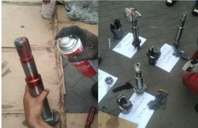
Gambar 4. 58 Pengujian Dye Penetrant pada Twistlock RTG di Pelabuhan Nilam (Sumber : Dokumen Pribadi)
