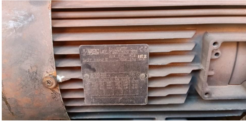
Gambar 4. 65 Gambar Motor Leroy Somer LSES 132M pada Power Pack Spreader Bromma SSX40
