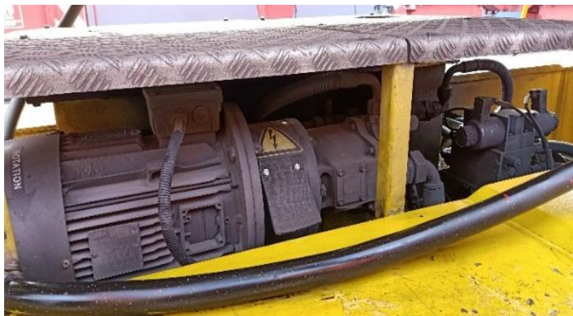
Gambar 4. 77 Power Pack Spreader Bromma SSX40 pada Container Crane 05 (Sumber : Dokumen Pribadi)
