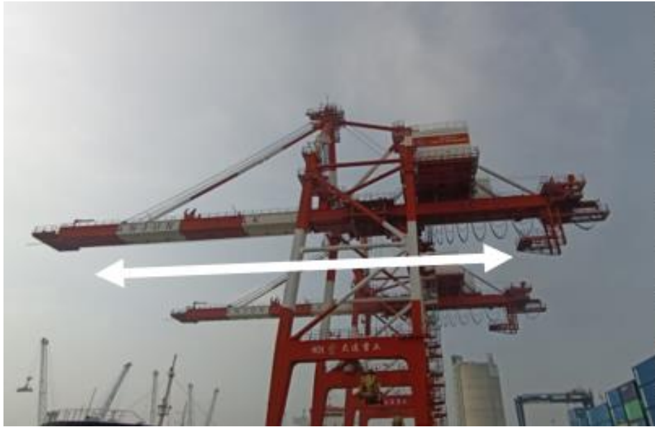
Gambar 4. 34 gerakan dan posisi girder pada CC 05
