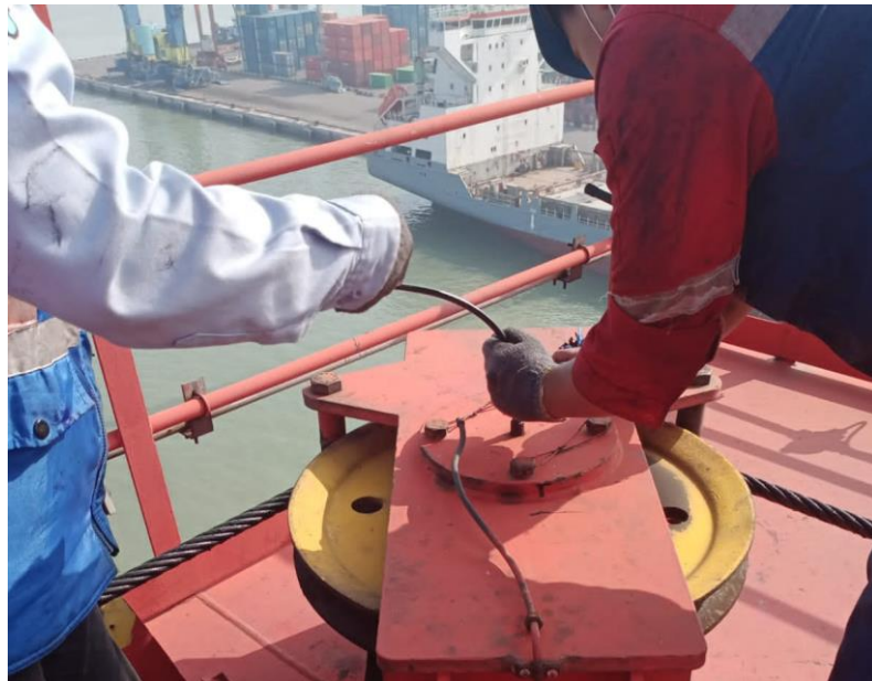
Greasing wire rope hoist dekat boom down pada CC 01
