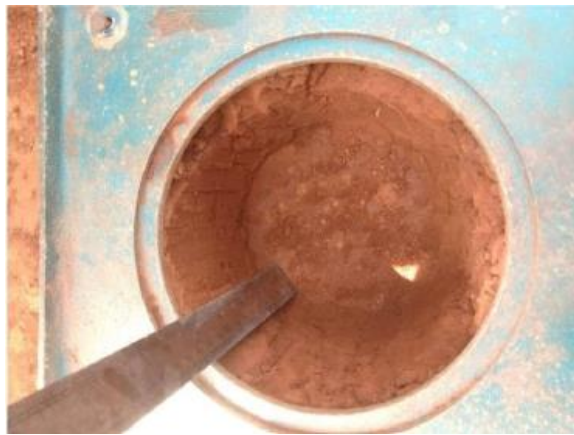
Gambar 4. 2 Lubang Galian untuk Pengujian Sand Cone
