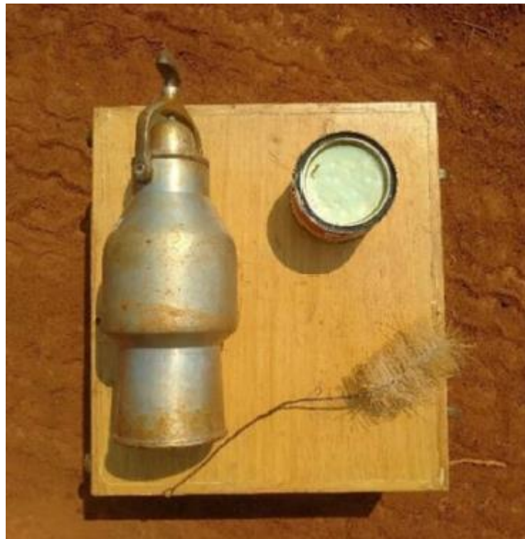
Gambar 4. 5 Alat dan Bahan Uji Kadar Air dengan Alat Speedy Test
