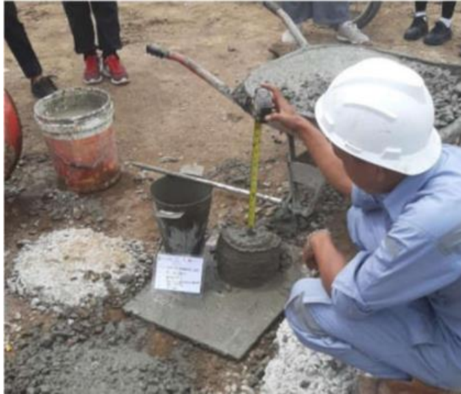
Gambar 3. 9 Pekerjaan Slump Test
