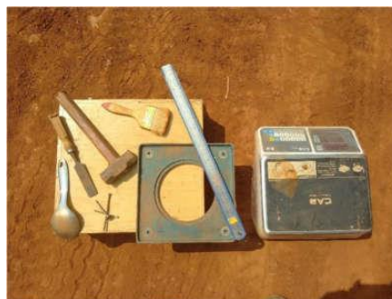
Gambar 4. 1 Alat Yang Digunakan Untuk Pengujian Sand Cone
