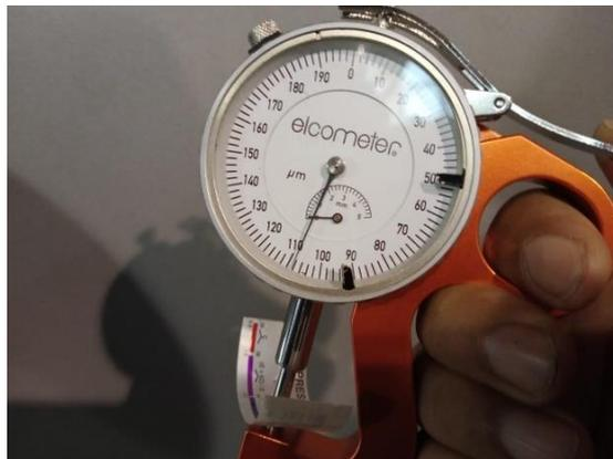
Gambar 4. 26 hasil pengukuran dengan surface profile gauge
