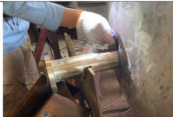
Observasi Penetrant Test pada sambungan Nozzle
