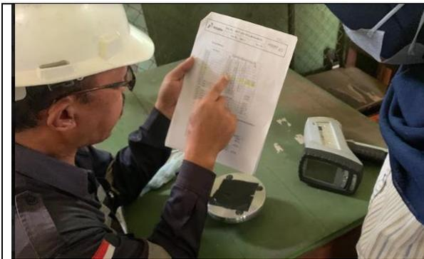
Melakukan PMI Test pada Raw Material
