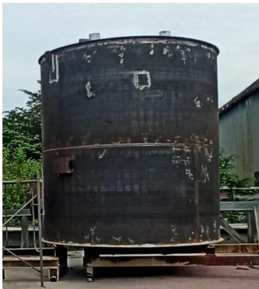
*Gambar 4. 22 sebelum vessel dilakukan sandblasting
