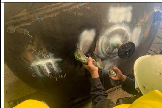
Melakukan Magnetic Test pada sambungan Nozzle
