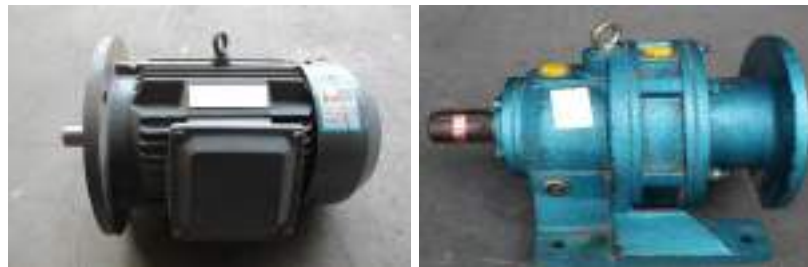
Gambar 4.29 Motor Listrik (utama) & Gear Box
