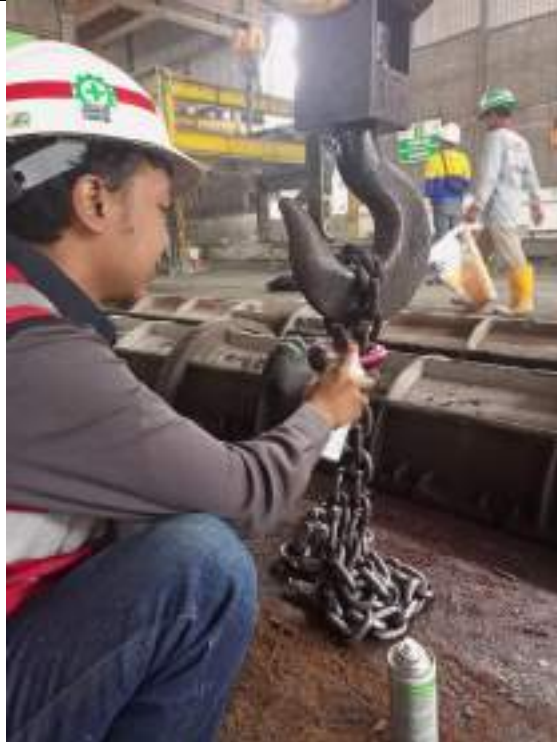
Pengujian NDT ( Non Destructive Test ) pada Overhead Crane di PT Adhi Persada Beton
