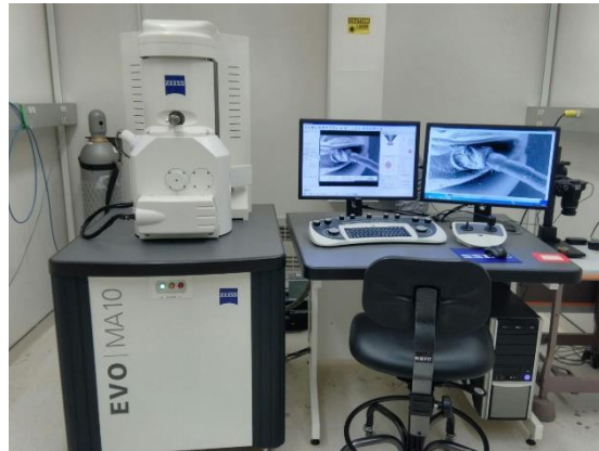
Gambar 3. 19 Mesin SEM-EDX Zeiss EVO MA 10
